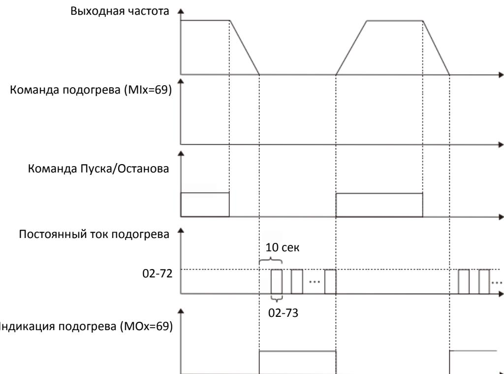
На рисунке ниже показан график работы функции предпускового подогрева при отсутствии дискретного входа с функцией 69 и периодом включения 50%. Функция подогрева включается после останова двигателя.
