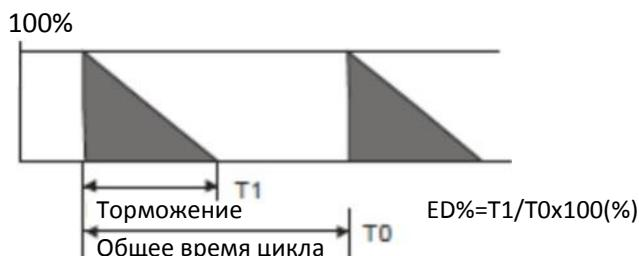
Комментарий: Расчётный ПВ (%) дает достаточно времени тормозному модулю и тормозному резистору рассеять тепло, выделившееся в результате торможения. Рекомендованное время цикла  $T_0$  составляет 1 мин.
